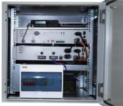
Рисунок 1.9.8 - Комплект звукоусилительного оборудования автономный БУ-СГС.
