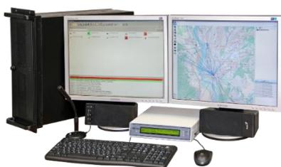
Рисунок 1.5.1 – Комплекс пункта управления оповещением ИТК ОС АРМ ОД.
