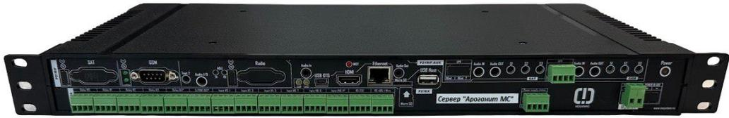
Рисунок 2.8.3 – Сервер мониторинга и управления «Ароганит МС»
