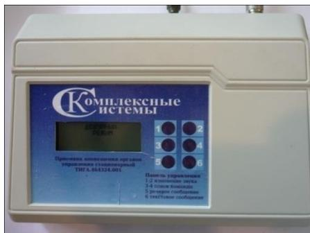
Рисунок 2.7.6 – Приемник оповещения органов управления стационарный.
