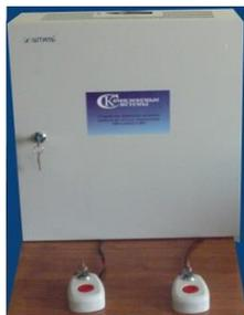
Рисунок 2.7.8 – Устройство передачи сигналов тревоги на пульта управления («Тревожная кнопка»).
